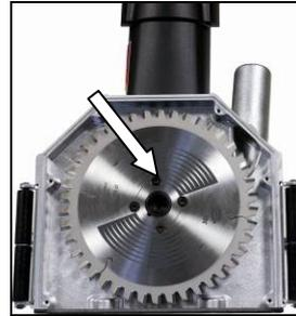
Montez la lame de scie sur la broche de travail dans l'ordre inverse. Tenez compte du fait que les trous d'abaissement de la lame de scie doivent montrer vers le haut! Pour faciliter le remplacement de la lame de scie, utilisez le dispositif de blocage de la broche pour contre-serrer.
