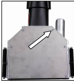
Desserrez les 6 vis à empreintes cruciformes et retirez la tôle de protection du fond.
